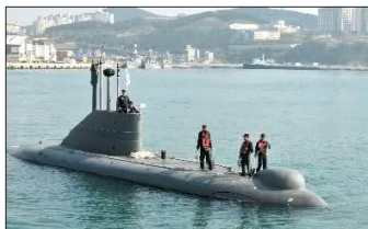
T.v. brittisk Piranha (26 meter), byggd 1978-80. I mitten en sydkoreansk Dolgorae efter modell från den västtyska IKL-70 (18 meter). T.h. skiss av den västtyska Typ 100 (20 meter). Alla dessa ubåtar är från ca 1980.
