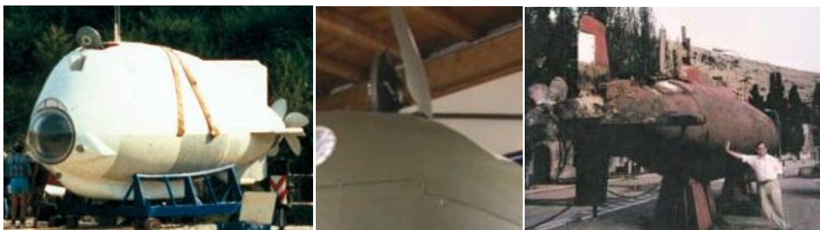
T.v. pilotexemplar av en 3GST9. En 10-meter lång äggformad farkost med en lucka på toppen. I mitten, luckan på toppen av den militära versionen av 3GST9 (se ovan). T.h. en ca 16 meter lång ubåt vid Svarta havet fotograferad under en amerikansk militärhistorisk resa 1992 (Lars Ulving i bild. Jag deltog också på delar av resan).
