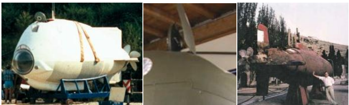
T.v. pilotexemplar av en 3GST9. En 10-meter lång äggformad farkost med en lucka på toppen. I mitten, luckan på toppen av den militära versionen av 3GST9 (se ovan). T.h. en ca 16 meter lång ubåt vid Svarta havet fotograferad under en amerikansk militärhistorisk resa 1992 (Lars Ulving i bild. Jag deltog också på delar av resan).
