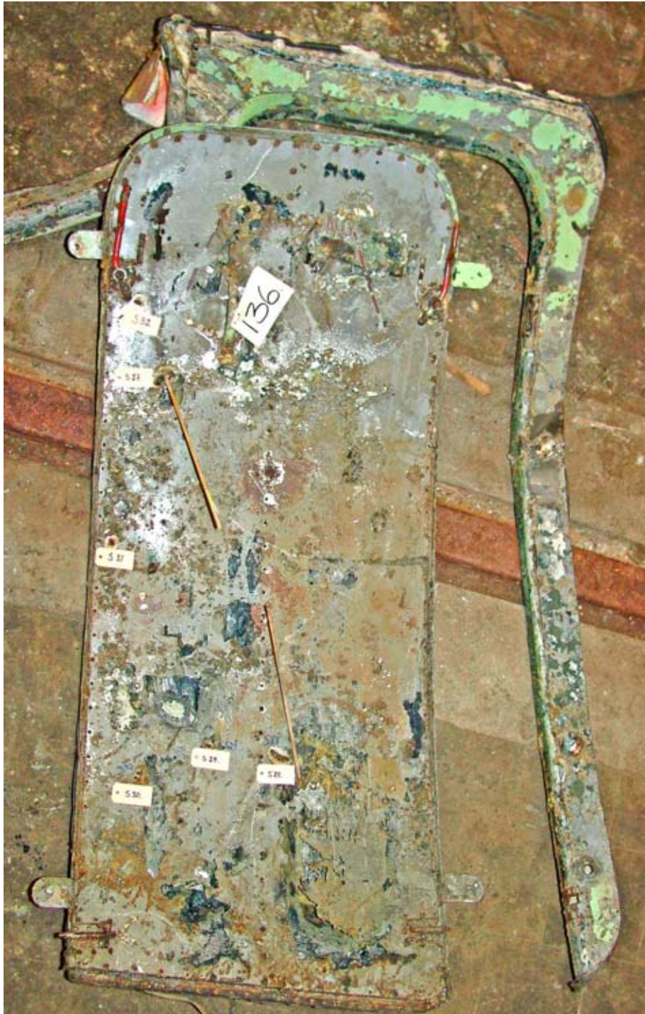
F136, nöddörr (Paratrooper Door) med F110, främre lastdörr. Foto 0081 CM.
