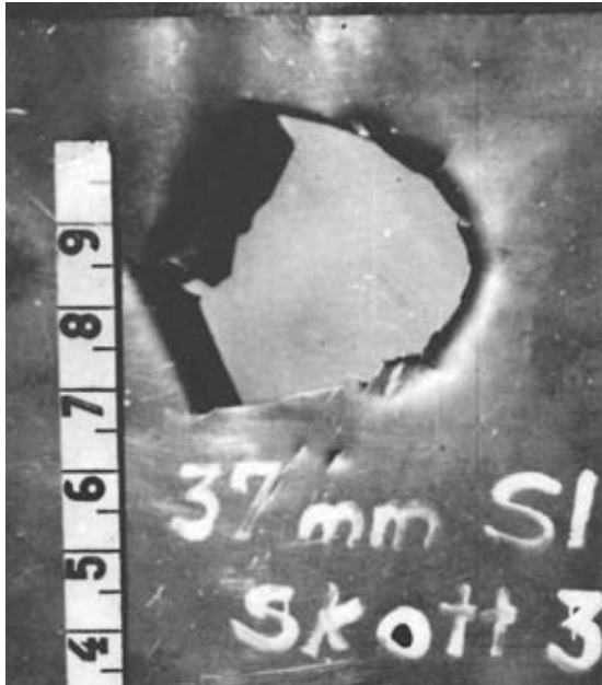
Verkan av 37 respektive 23 mm slsg i 2 mm duralplåt. Observera att mätstickan är graderad i dm. Hålet från 37 mm granat är ca 310x330 mm och det från 23 mm ca 100x140 mm.
