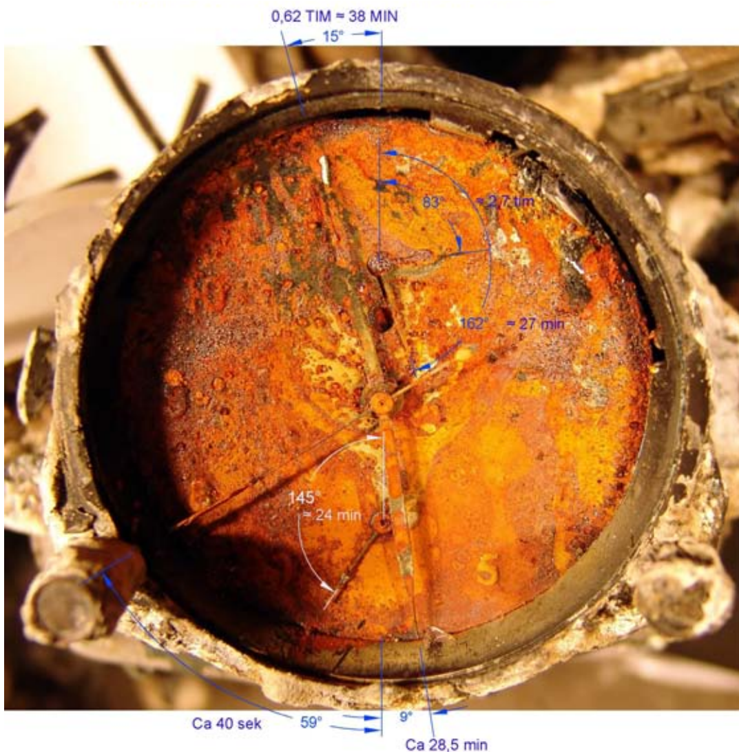
F130, flygplanur från cockpit. Klockan har stannat på ca 11:28:40, flygtiden på 2:27 och tersuret på 24 min.
