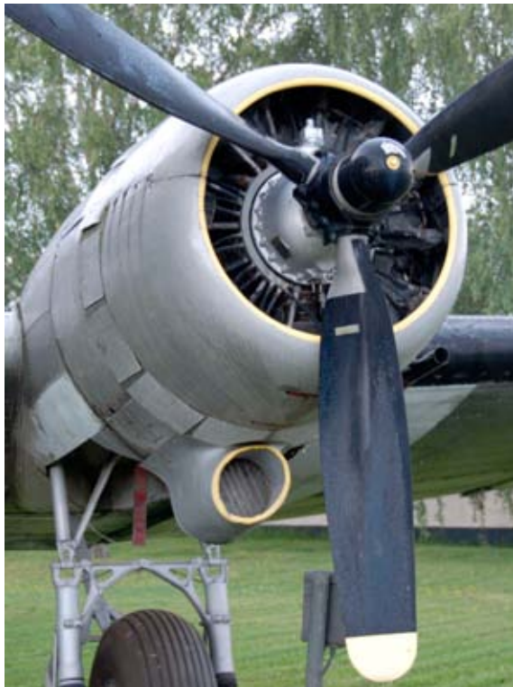
Vänster motor på 79002 med oljekylare undertill. Foto 0414 CM.
