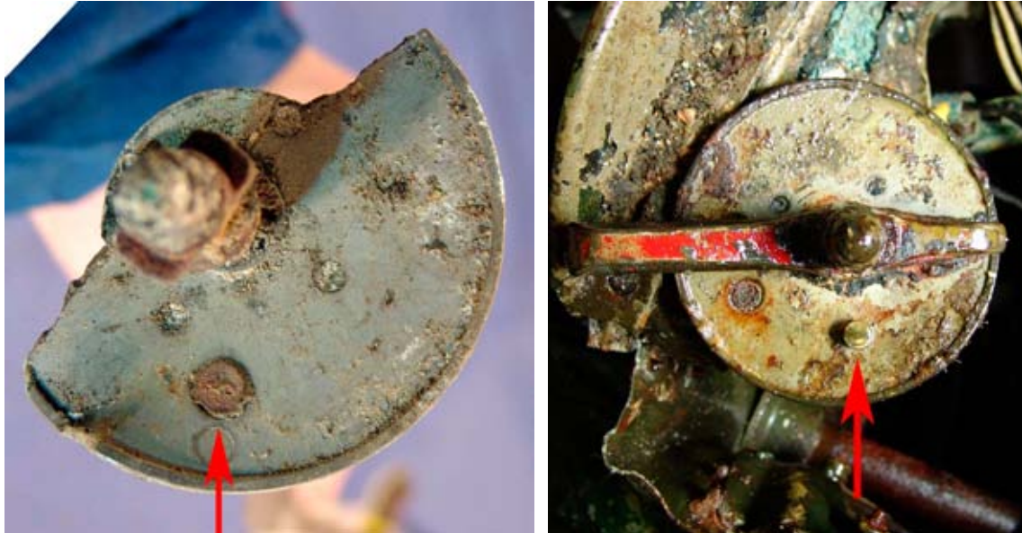
Tankväljare vänster respektive höger. Observera den runda piggen nertill (vid pilen) som markerar rakt bakåt. Tankväljarna står i läge LEFT resp. RIGHT AUX. Foto 04260 o 00900 CM.
