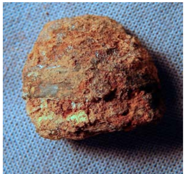
Till vänster syns splitter T062 resp. T063. I höger bild splitter T063. Observera spåren av gängor upptill på T063 i vänster bild.
