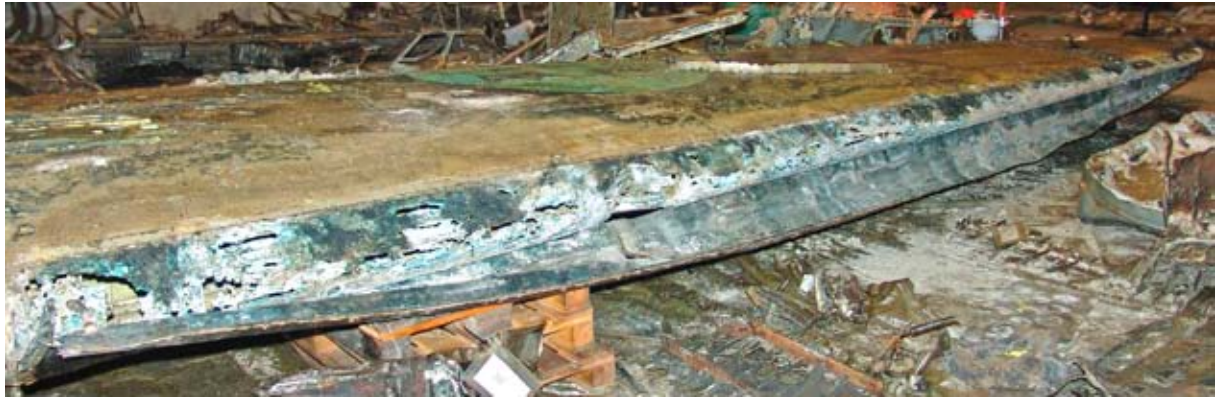
Vänster vinge med delvis avtagen gummiblåsa.
