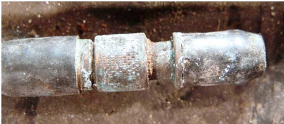
Muninblåsningsventil till flytväst P134 i osäkrat läge.
