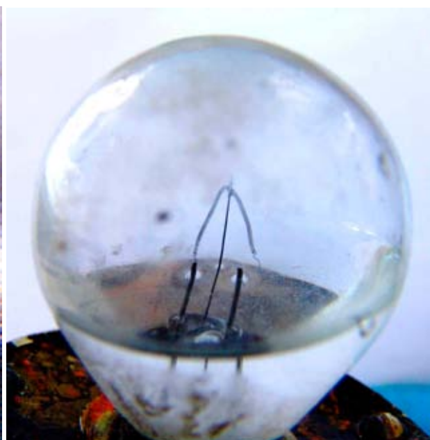
T067 från höger sarg i cockpit. Sträckt glödtråd! T348, från innerbelysning. Ej sträckt glödtråd! Foto 01145 o 02348 CM.
