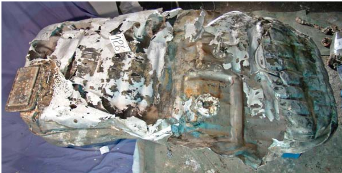
F126, undersida av vänster främre bränsletank ("Main Fuel Tank").
