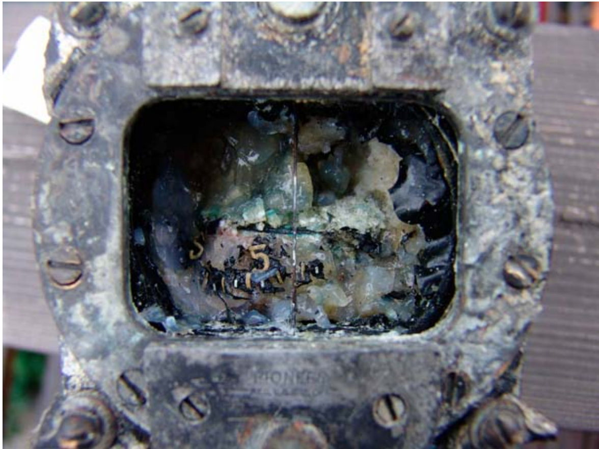
T347, magnetkompass. S betecknar söder och 1 framför 5 saknas. Aktuellt läge motsvarar ca 135°. Foto 02992 CM.
