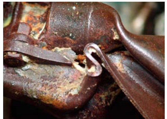
Detaljbild på vänster landställ. Observera böjningen av stålfläns.
