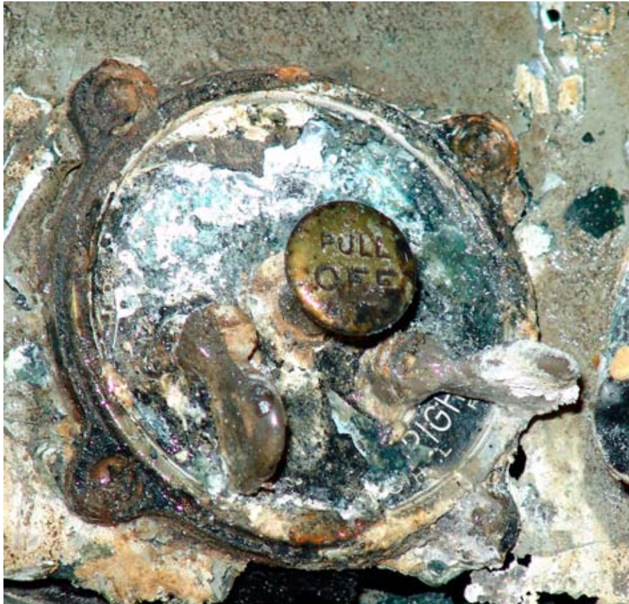
Magnetomkopplare. Vänster står i läge OFF och höger i läge R. Foto 03280 CM
