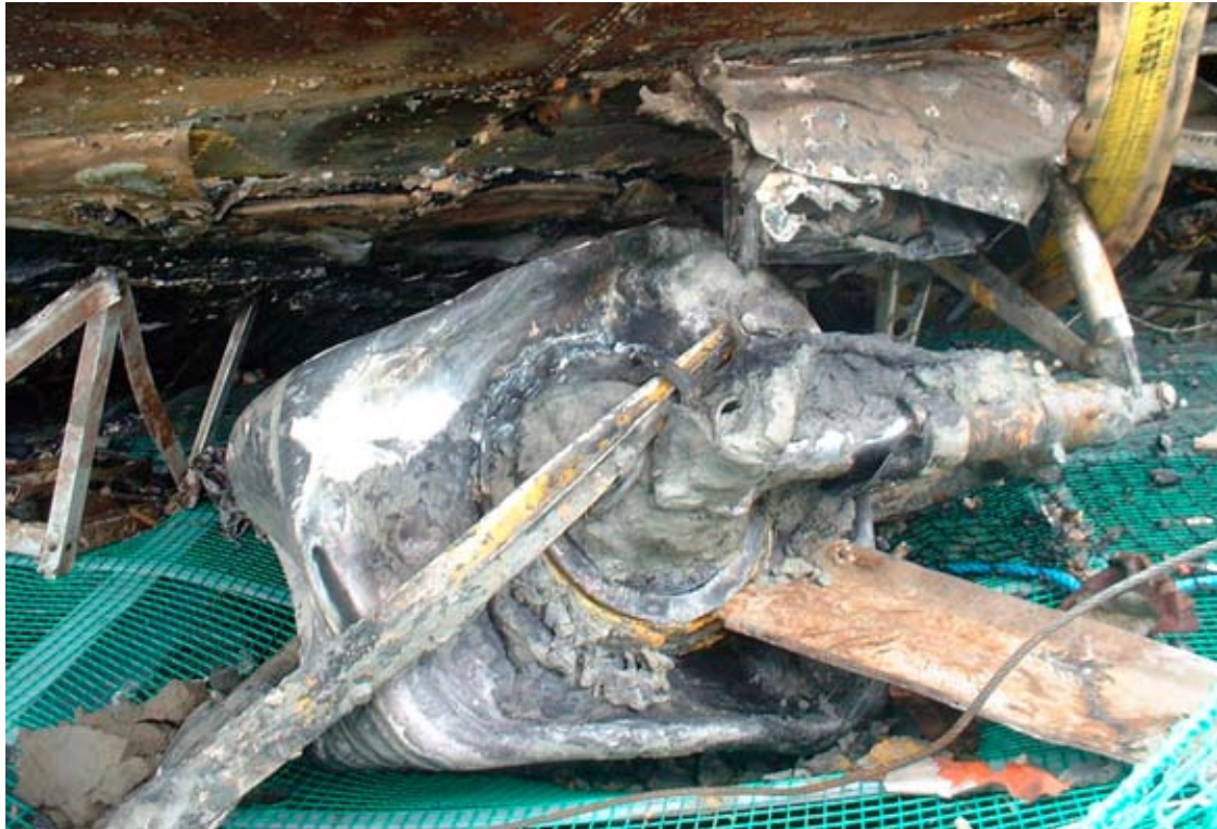
Höger landställ dagen efter bärgningen. Fillet-plåtar bakom stället har tryckts upp mot vingens undersida av landställshjulet. Foto 5175 PD.
