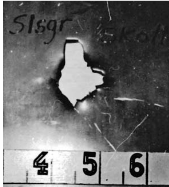
Verkan av 37 respektive 23 mm slsg i 2 mm duralplåt. Observera att mätstickan är graderad i dm. Hålet från 37 mm granat är ca 310x330 mm och det från 23 mm ca 100x140 mm.
