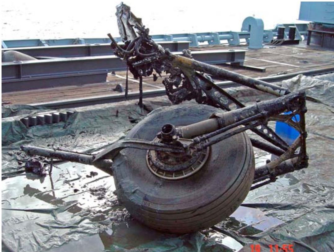
Vänster landställ på Belos däck efter bärgning hösten 2003.
