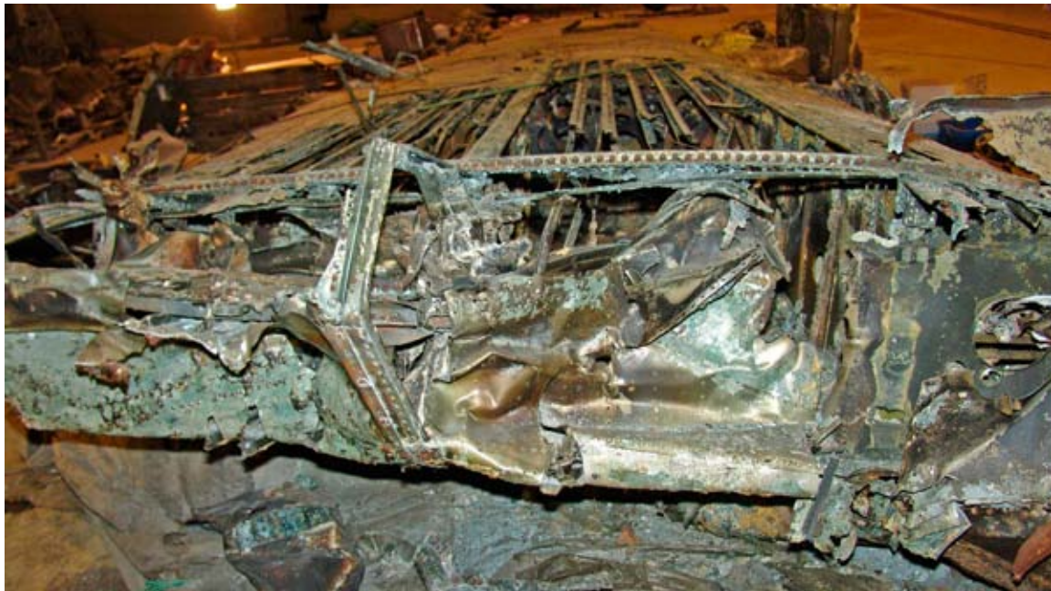
Inre del av vänster vinge. Bultförband mellan mitt- och yttervinge syns tydligt.
