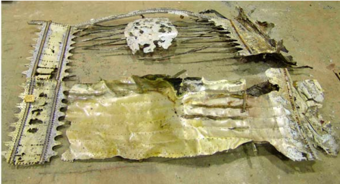
Skrovplåt från undersida av mittvinge under främre (övre del av bild – T026) och bakre vingtank (nedre del av bild – F129). Foto 01416 CM.
