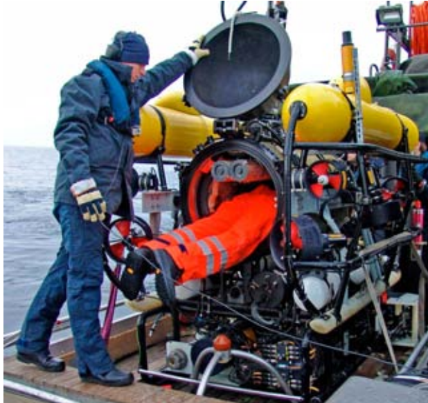
Mantis undervattensfarkost på Furusund. Till vänster kryper Niklas Eliasson in i farkosten. Till höger ses farkostens för med glaskupol och griparmar.
