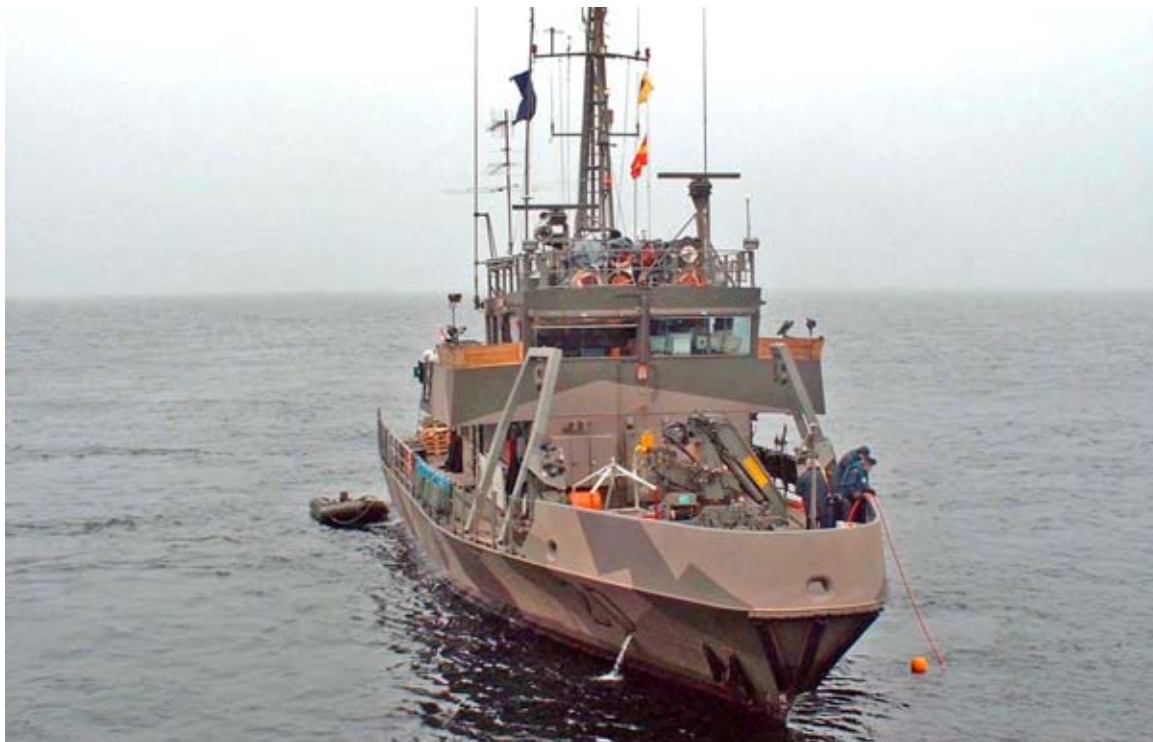
Furusund den 17 mars med Mantis i arbete. OBS, Mantis försörjningskabel i fören. Foto 5062 PD.
