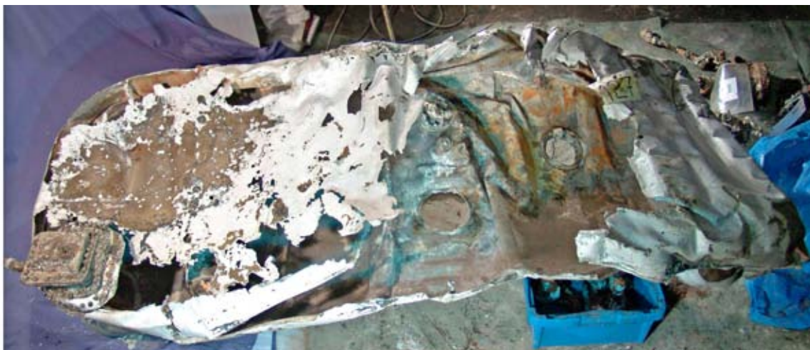
F127, undersida av vänster bakre bränsletank ("Auxiliary Fuel Tank").
