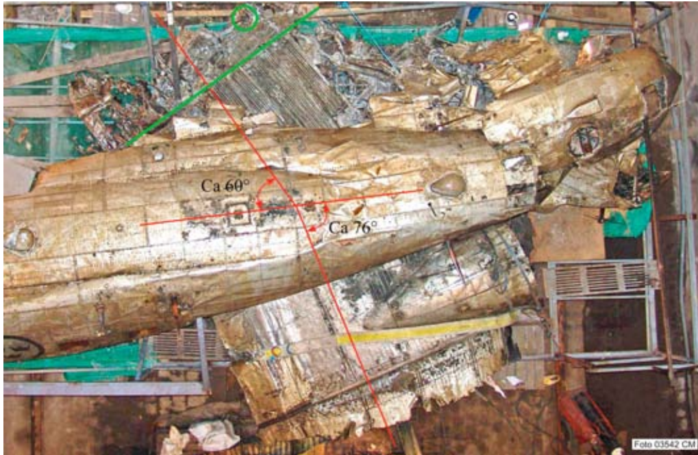
Bild ovanifrån av flygplansskrov med mittvinge. Mittvingen är kraftigt vriden relativt flygplansskrovet. Höger del är vriden ca 14° framåt medan vänster del är vriden ca 30° bakåt.
