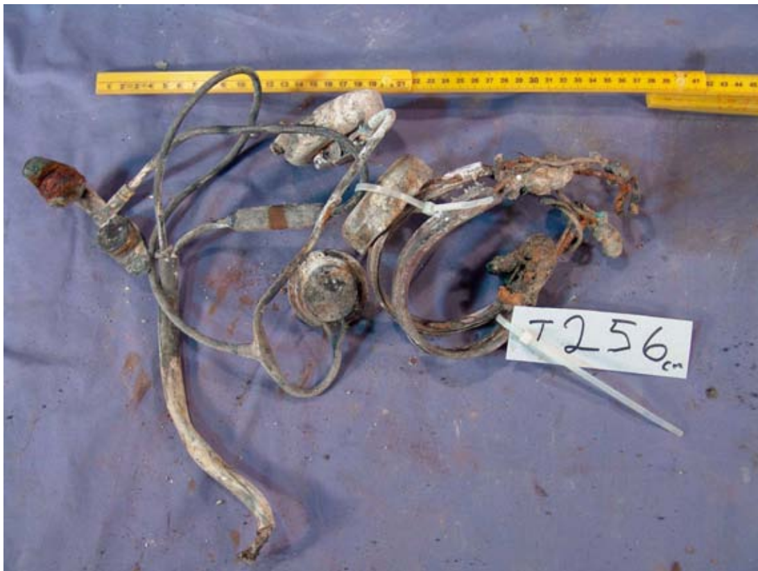
T256, headset och strupmikrofon, troligen navigatörens.
