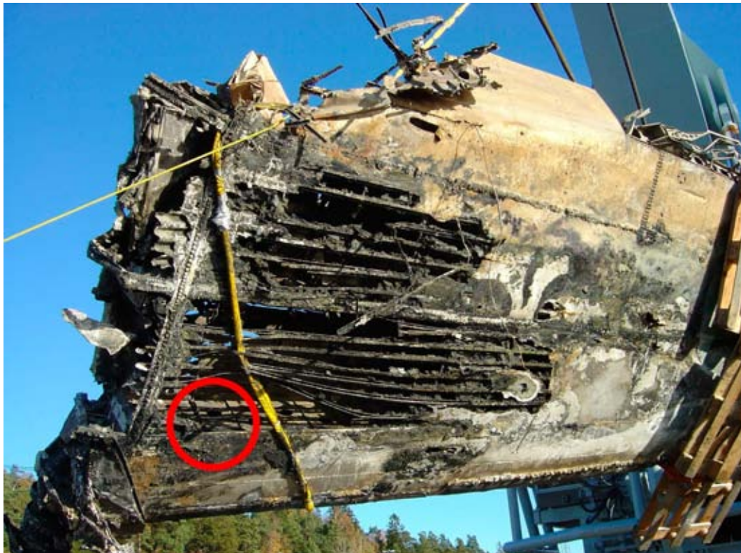
Ovansida av vänster vinge (B222). Prov A har markerats med röd ring.
