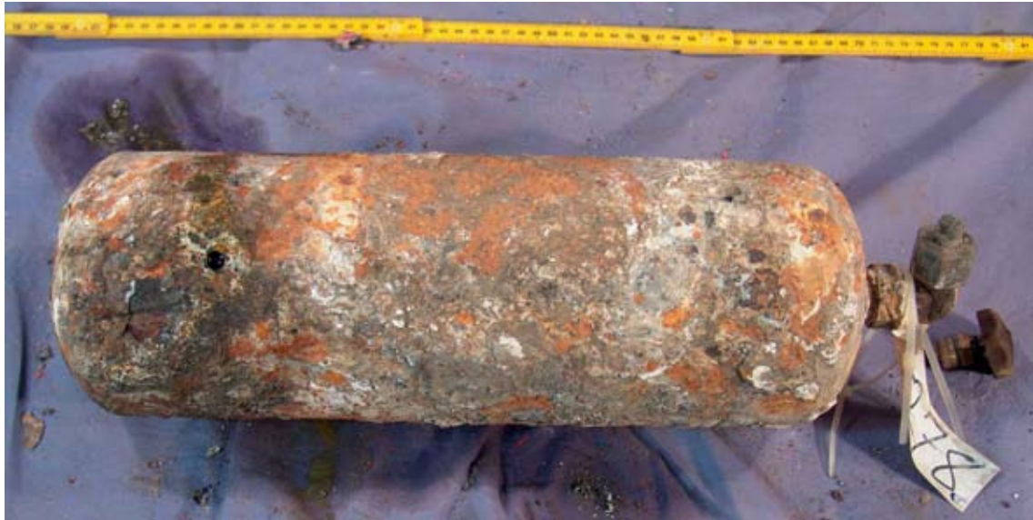
T278, syrgastub från cockpit. Hål borrades, varvid vatten rann ut.
