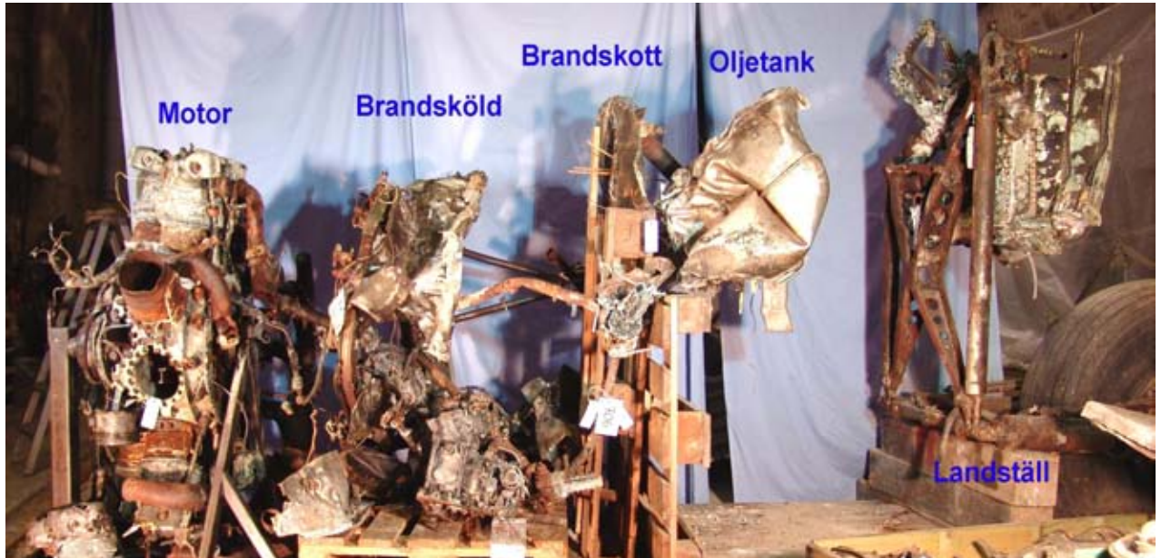
Motor, brandsköld, motorupphängning, brandskott, oljetank och landställ uppställda med ungefär samma inbördes avstånd som i flygplanet.
