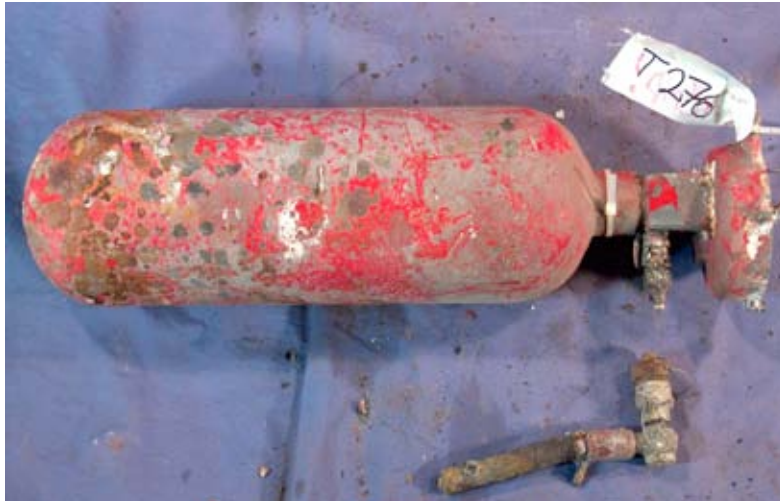
T276, motorbrandsläckare. Till höger ses mekanismen (ej utlöst).
