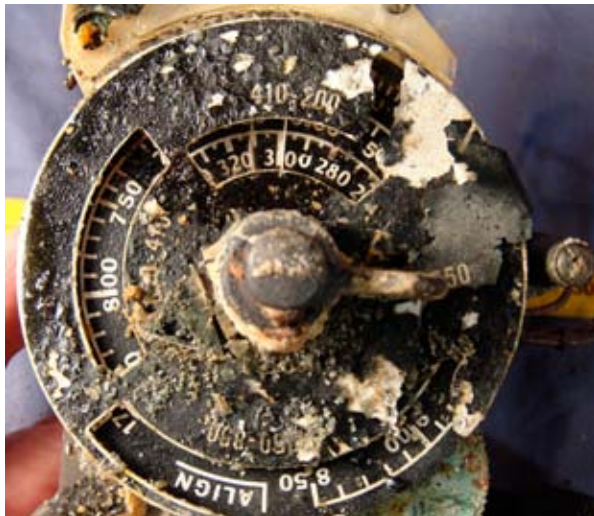
T255, panel till flygradiopejl (Frp 3). Inställd på ca 300 kHz. Foto 01165 CM.
