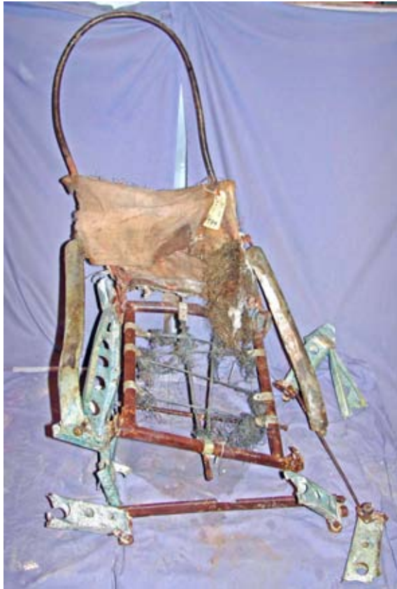
Gruppchefens stol T089 respektive vänster fäste för säkerhetsbälte på T089.
