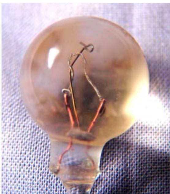
T067 från höger sarg i cockpit. Sträckt glödtråd! T348, från innerbelysning. Ej sträckt glödtråd! Foto 01145 o 02348 CM.
