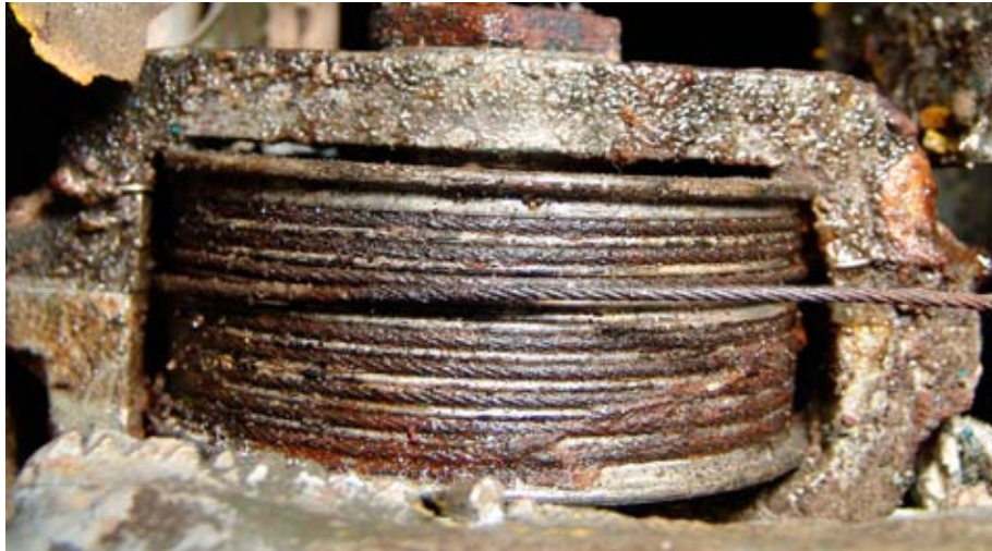
Sidtrimvajerens läge på lintrumman indikerar trimläge ca 6° nos höger. Foto 01991 CM.
