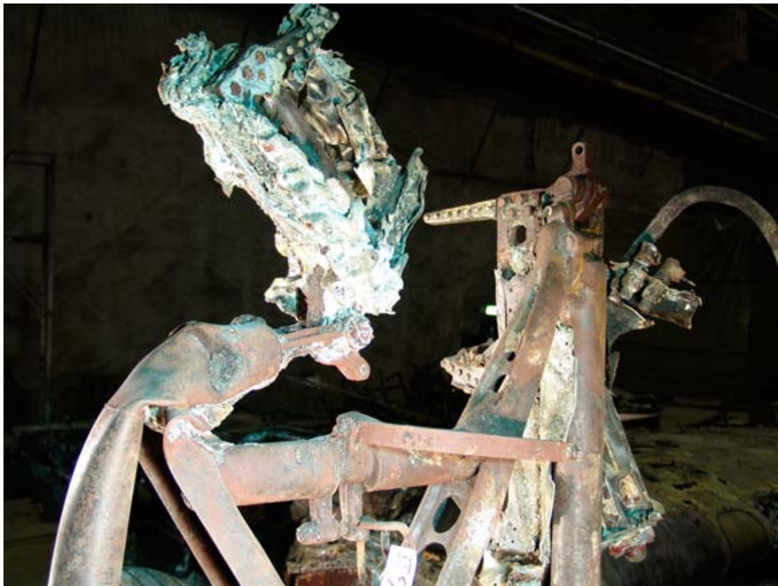
Höger landställsben framifrån. Observera den kraftiga vridningen på det högra benet (till vänster i bild).
