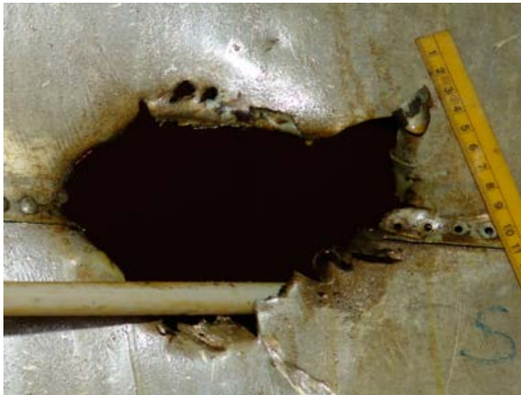
S04, granatträff i flygplanets bakre del. Observera de två små hålen ovanför det stora. De visar att granaten detonerat omedelbart vid träff i skalplåten.
