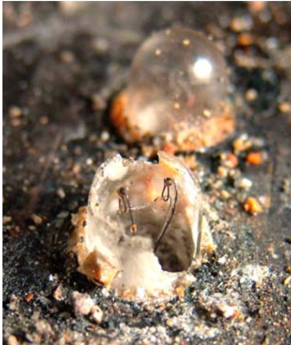
Glödlampor till grön respektive röd landställsindikering.
