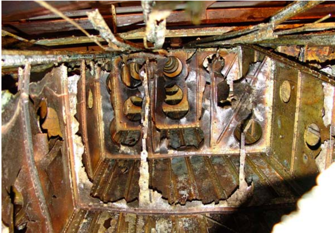
Mörkbruna avlagningar i vänstervingen. Sett från vingroten.
