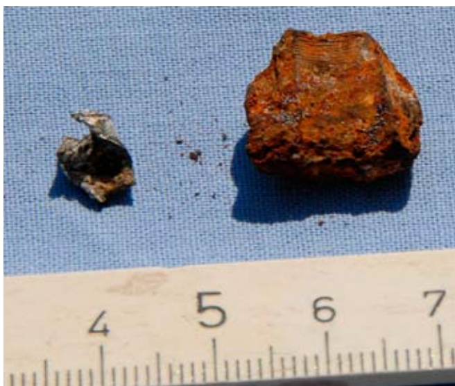
Till vänster syns splitter T062 resp. T063. I höger bild splitter T063. Observera spåren av gängor upptill på T063 i vänster bild.
