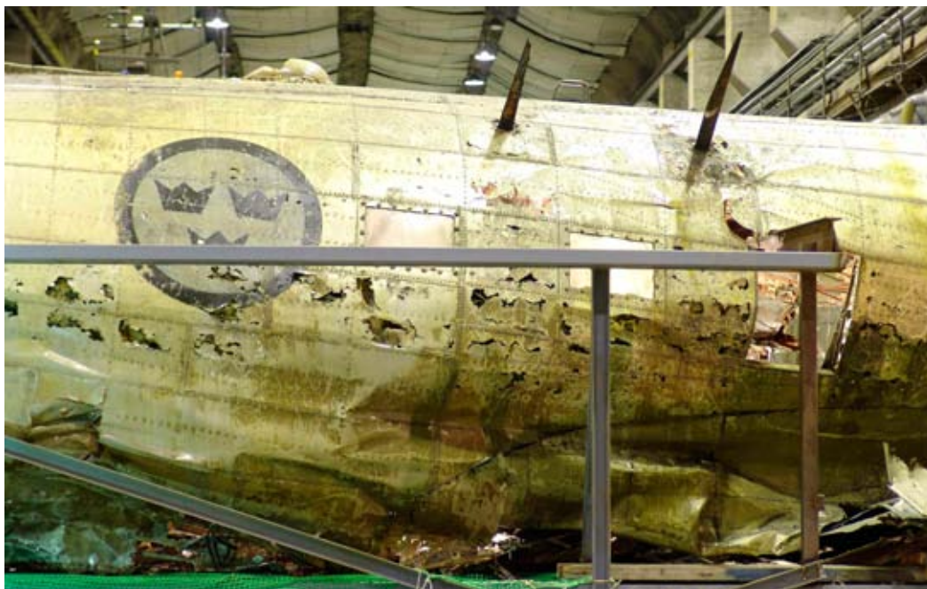
Höger sida av flygplansskrov. Prov 1 och 2 har tagits under kronmärket. Foto 00928 CM.
