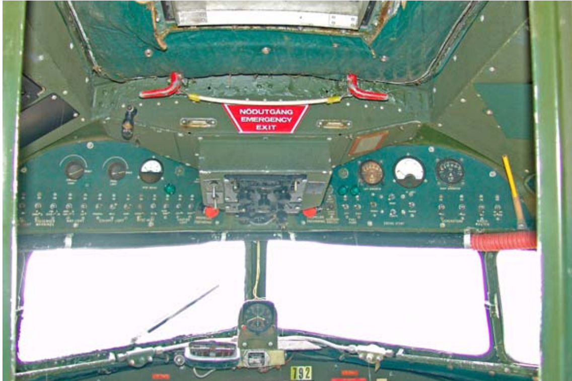
79002 instrumentpaneler i cockpit-tak. Strömbrytare och instrument avviker i många avseenden från 79001. Observera nödluckan i taket. Foto 02156 CM.
