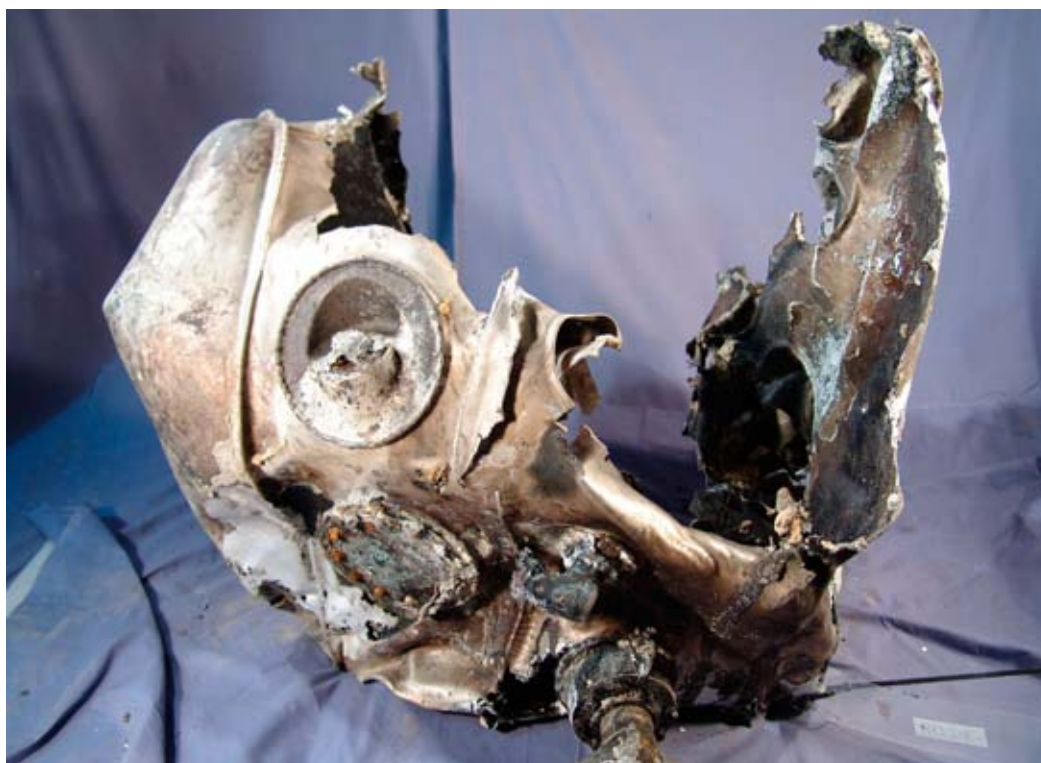
B8074, vänster oljetank, undersida.
